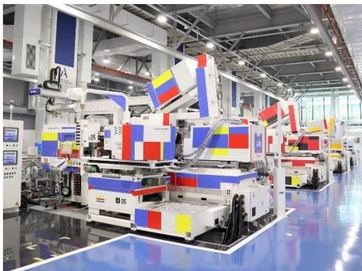
【成形機】プラスチックを加熱し、金型に流し込み、圧力をかけて成形する機械。生産力強化のため、2026年度の新工場本格稼働時には、多色成形機10台、単色成形機84台を使用。
