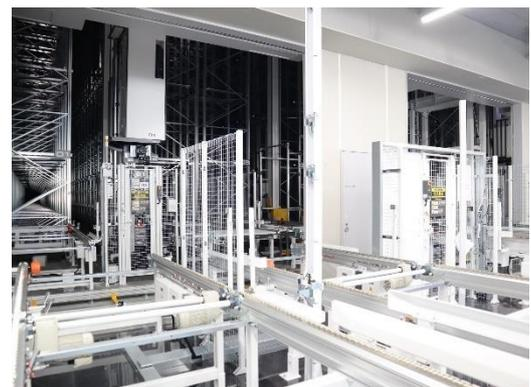
【自動倉庫】1階～3階を縦断する倉庫。トラックヤードでの入出庫時に活用。入庫した原料や金型、出庫する完成品のプラモデルなどを、自動で指定棚へ運搬。
