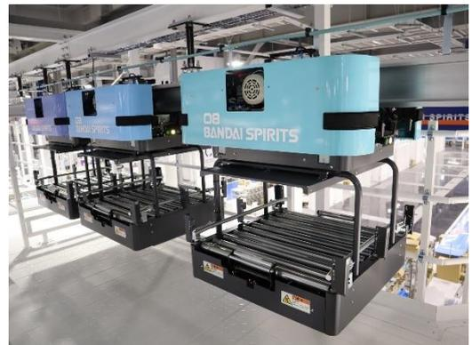
【天井搬送台車】1階成形フロアの天井を周回する台車で、成形品を入れたコンテナを自動システムで運搬。自動化とともに空間・動線を有効活用する。全15台。
